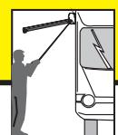
**Abb.1 :** Um die Markise, aber vor allem die Fahrzeugwand, nicht sinnlos zu belasten, müssen - nach ungefähr 1m Auszug - die Stützbeine auf den Boden gesetzt werden. Anschließend weiter ausdrehen und die Stützen gemäß dem erreichten Auszug versetzen.
