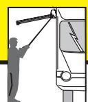
Fig. 1 : Pour éviter de forcer sur le store ou sur la paroi du véhicule, il est nécessaire de sortir les pieds du store dès qu'il est déroulé d'environ 1m.
