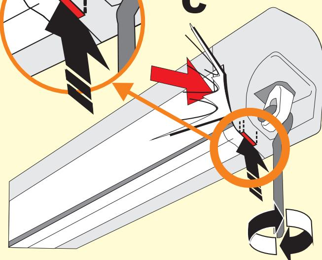
(DE) Bei komplett eingefahrener Markise ist die rote Anzeige nicht mehr sichtbar. Die Markise ist jetzt verriegelt. Die Verriegelung erfolgt ohne spürbaren Widerstand.
